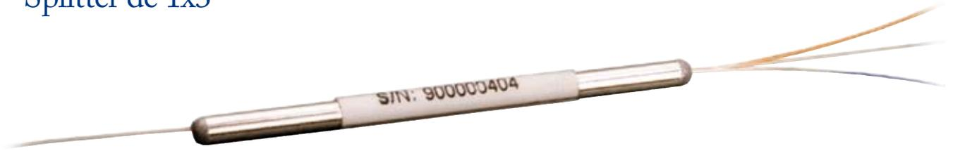
Los splitters bidireccionales de alto rendimiento en monomodo de Cmatic se usan para bifurcar la luz de una fibra a 3 fibras salientes con una pérdida ultra baja. Estos dispositivos son splitters compactos de fibra fabricados según el proceso Bicónico de Fusión (FBT) de último modelo. Los splitters operan en longitudes de onda de 1310 y 1550nm.
