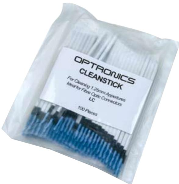
Son el consumible ideal para limpiar elementos de 1.25mm después de la instalación. Se usan para limpiar los extremos de los conectores que están instalados en la parte interior de las cajas o paneles. La limpieza se logra insertando la punta de microfibra dentro de la apertura del adaptador, girando el bastón una vez.
