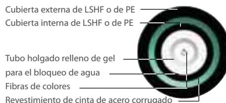
Diseño para el bloqueo de agua en la cubierta doble
