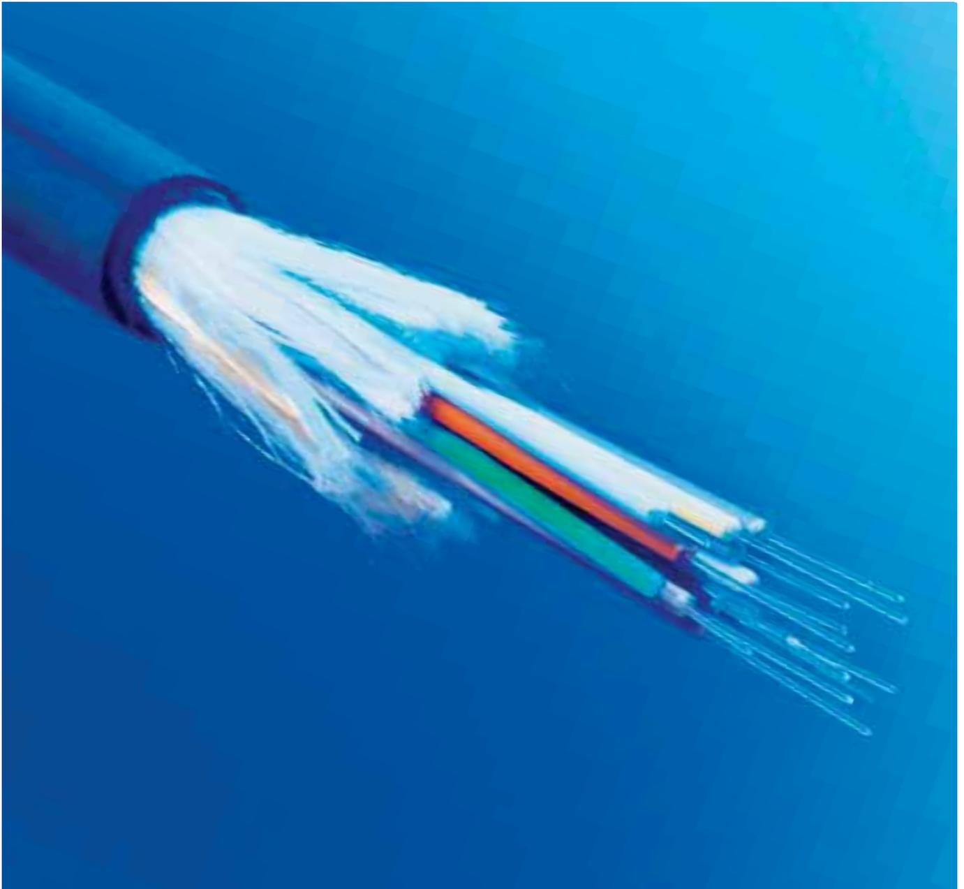
Los cables de tubo holgado FibrePlus se venden en construcciones unitubo o de multitubo holgado y están disponibles en tres variantes estándar. Los cables multitubo holgado están disponibles de forma estándar en 6 x 4 fibras por tubo, 6 x 12 fibras por tubo, 8 x 12 fibras por tubo, 12 x 12 fibras por tubo y 24 x 12 fibras por tubo, y tienen disponibles hasta un máximo de 288 fibras.
