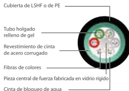
Cubierta de LSHP o de PE
