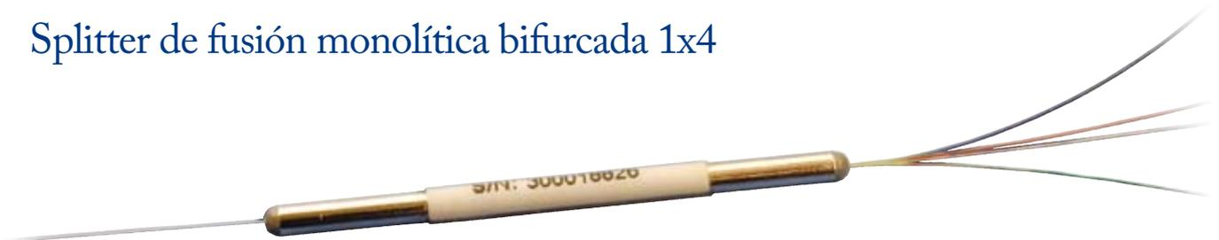
Los splitters de 1x4 de fusión de Cmatic están específicamente diseñados para “La fibra para el hogar” (FTTH). Usando la última tendencia del proceso Bicónico de Fusión (FBT), este artículo muestra un rendimiento uniforme en la banda óptica que comprende desde los 1260 a 1630nm con cerca de tener cero pérdidas por exceso. La trayectoria óptica libre de epoxy de los Splitter de fusión monolítica bifurcada ofrece una buena disposición a la hora de su manejo.
